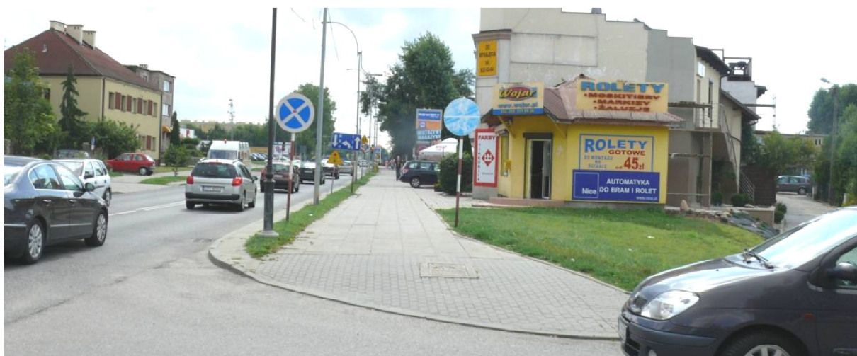
Rys. 2.20 Przerwanie drogi rowerowej ciągiem pieszo – rowerowym
